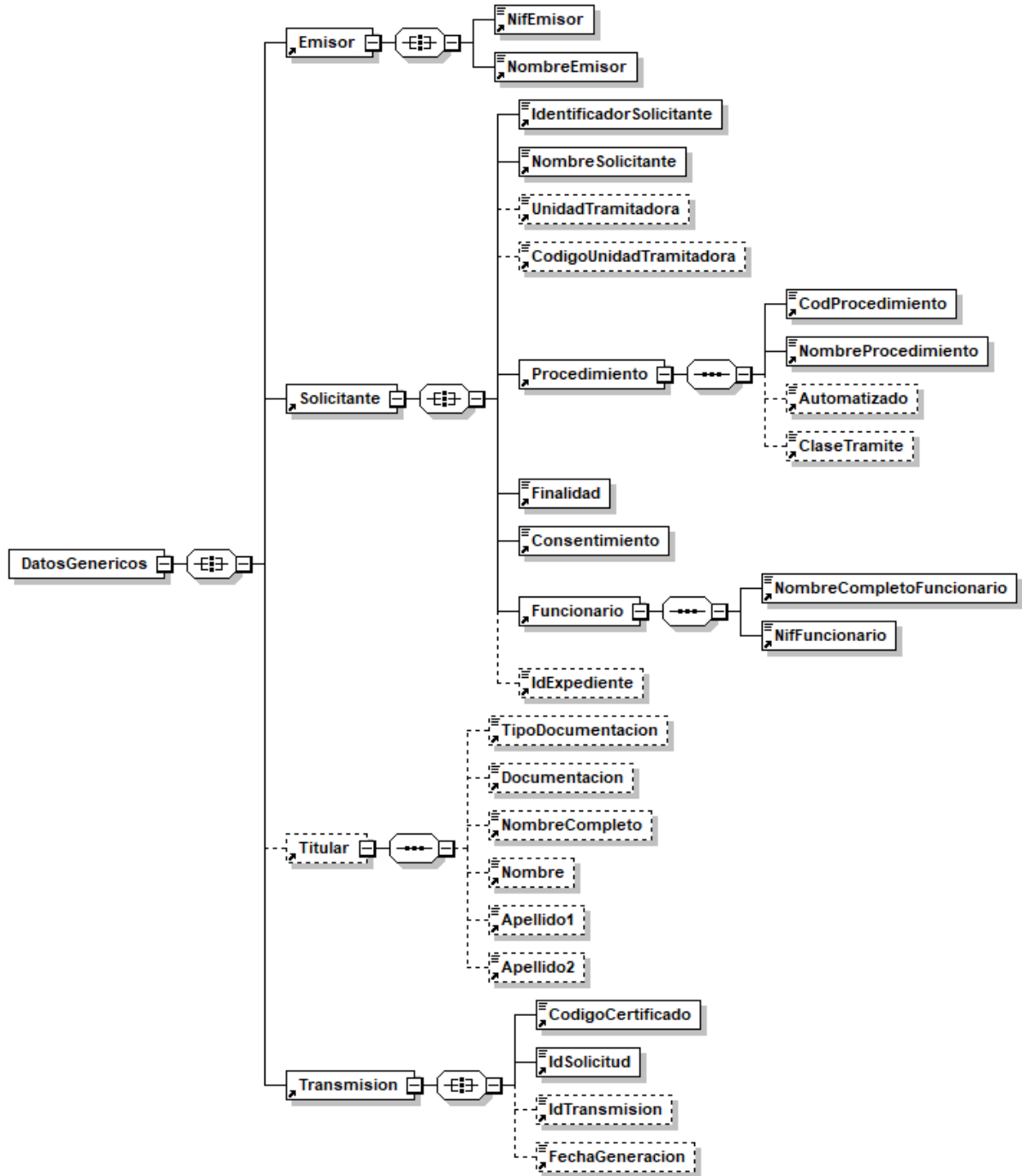
Figura 6. Diagrama de la rama de DatosGenericos del mensaje de Peticion del Servicio
