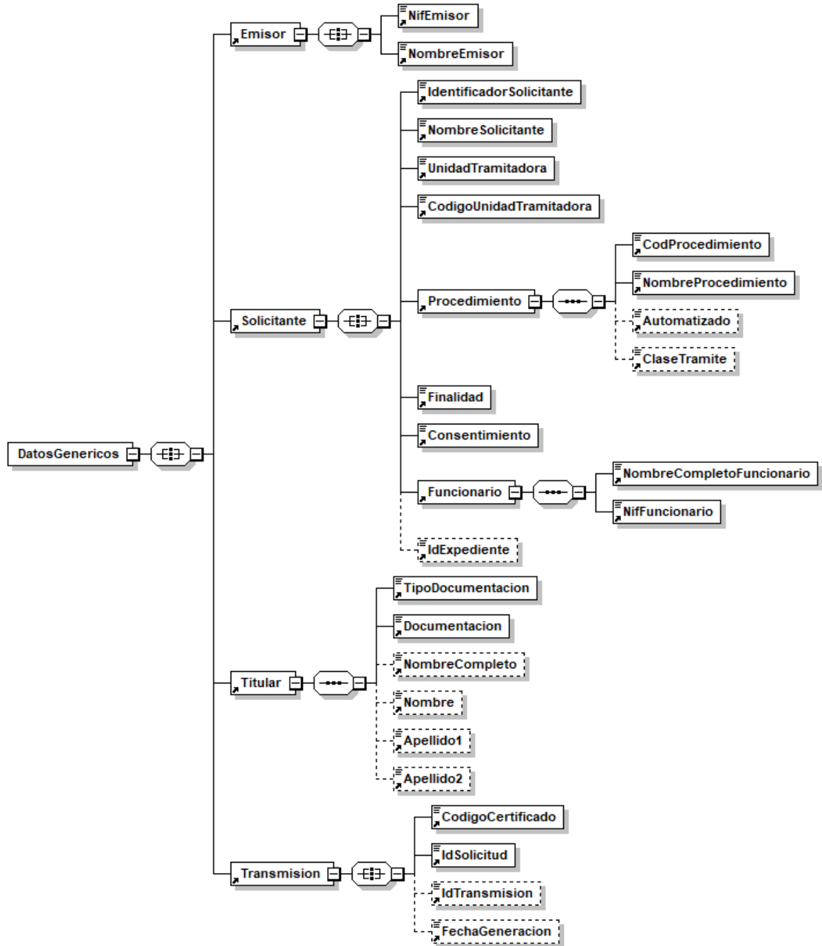
Figura 4. Diagrama de la rama de DatosGenericos del mensaje de petición del Servicio
