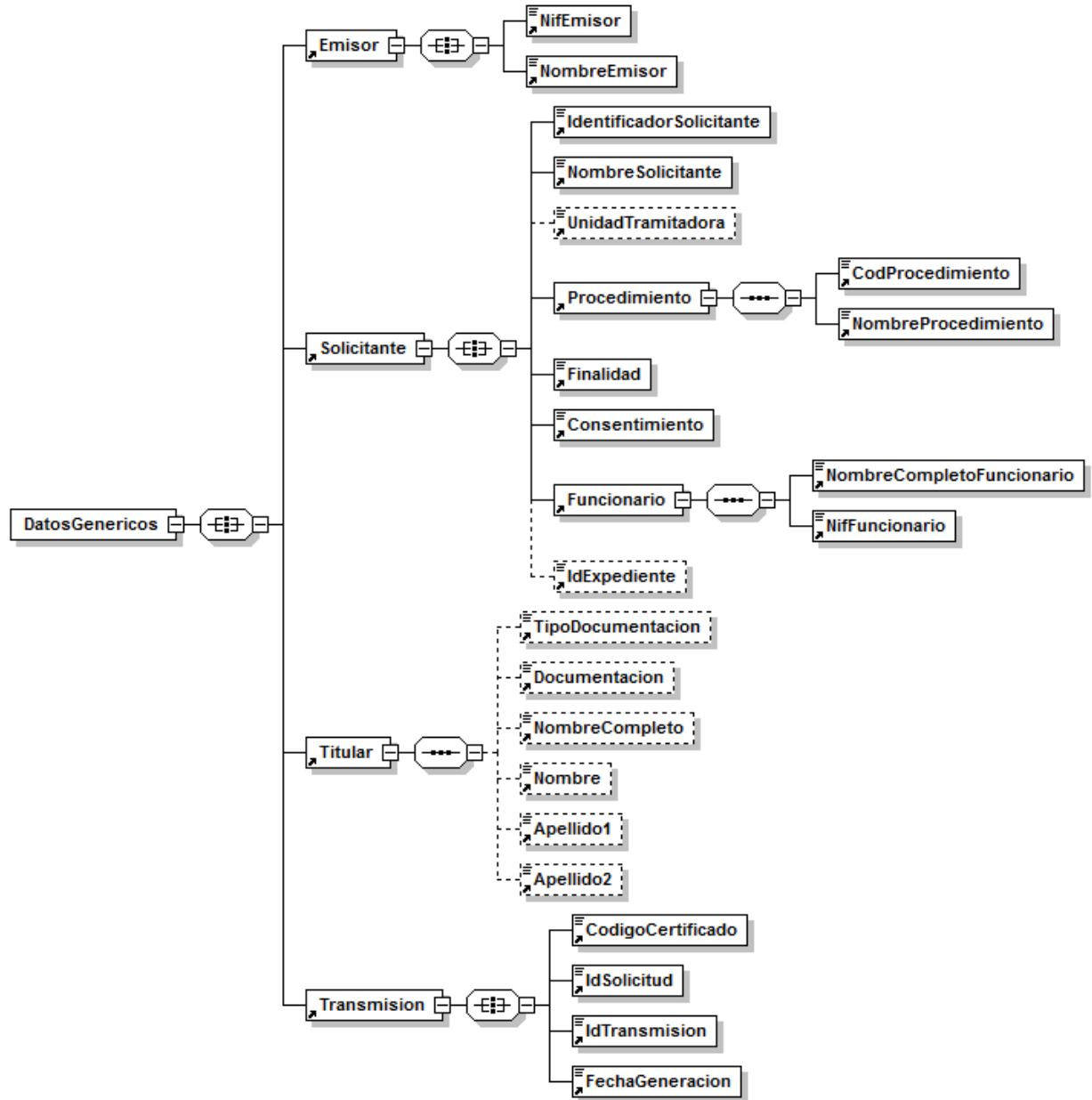
Figura 8.- Contenido del Nodo DatosGenericos del Servicio de obtención del Certificado de Prestaciones
