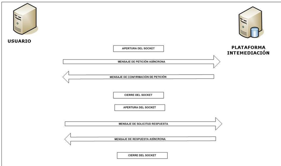
Figura 2.- Diagrama de comunicaciones de las peticiones asíncronas
