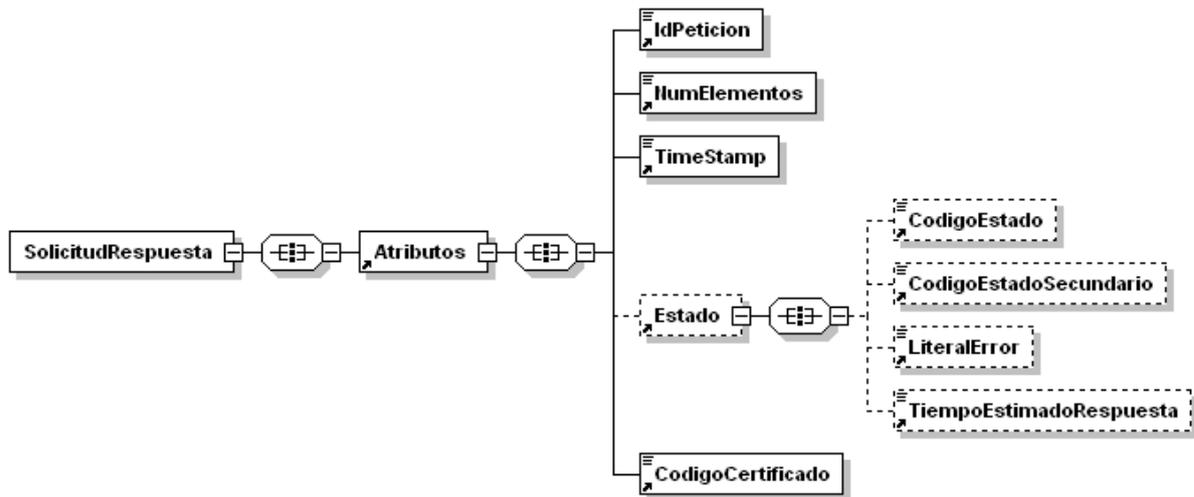
Figura 10.- Diagrama del mensaje de Solicitud de Respuesta del Servicio
