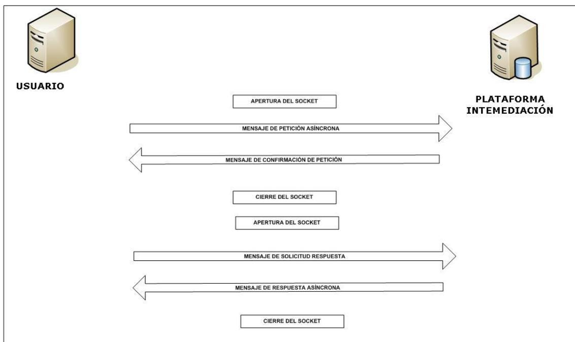
Figura 2.- Diagrama de comunicaciones de las peticiones asíncronas
