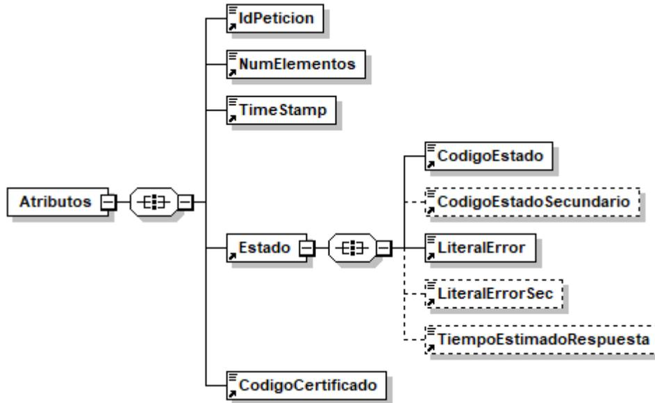
Figura 7.- Diagrama del mensaje SOAP Fault del Servicio
