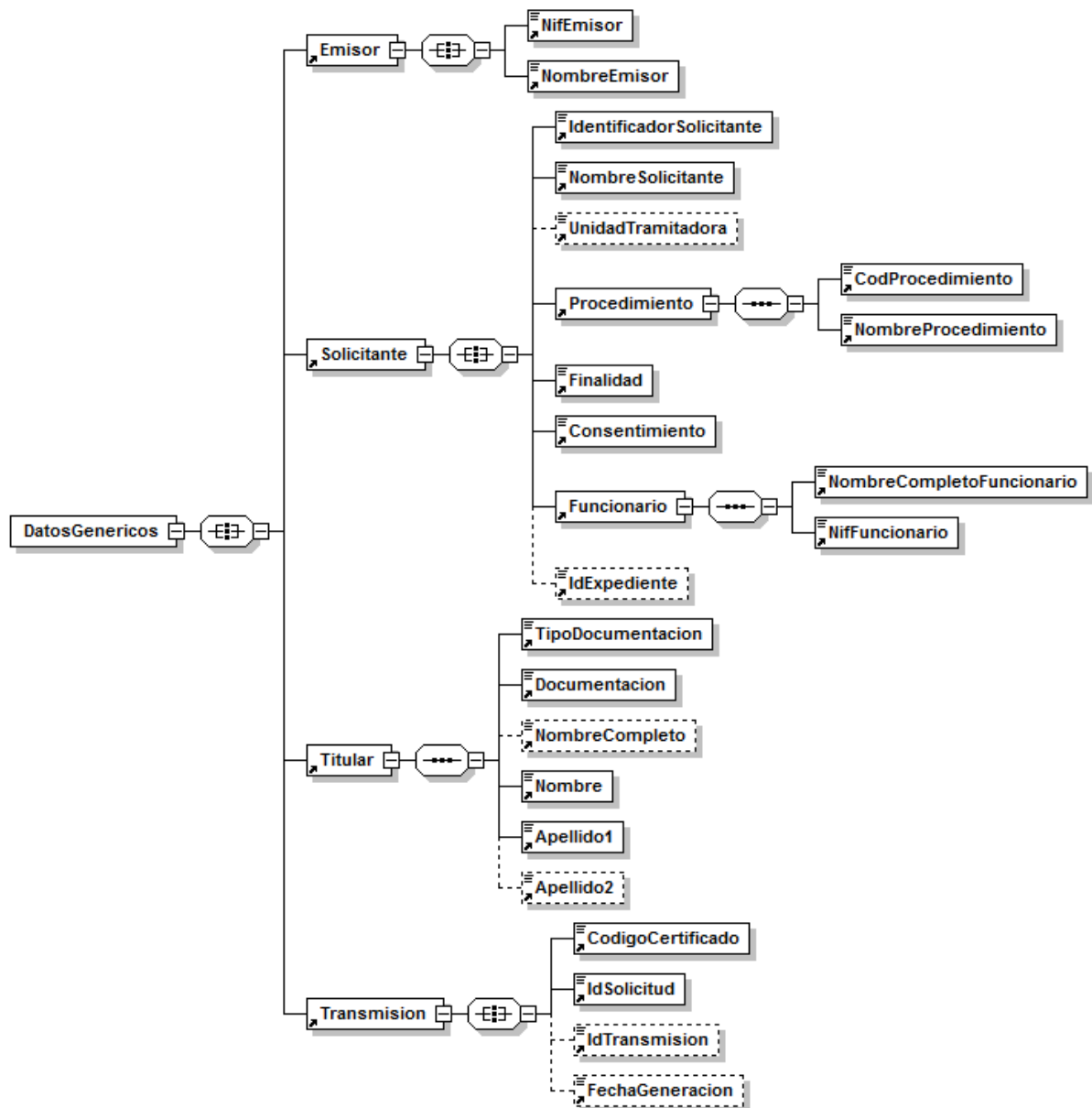
Figura 6. Diagrama de la rama de DatosGenericos del mensaje de petici3n del Servicio
