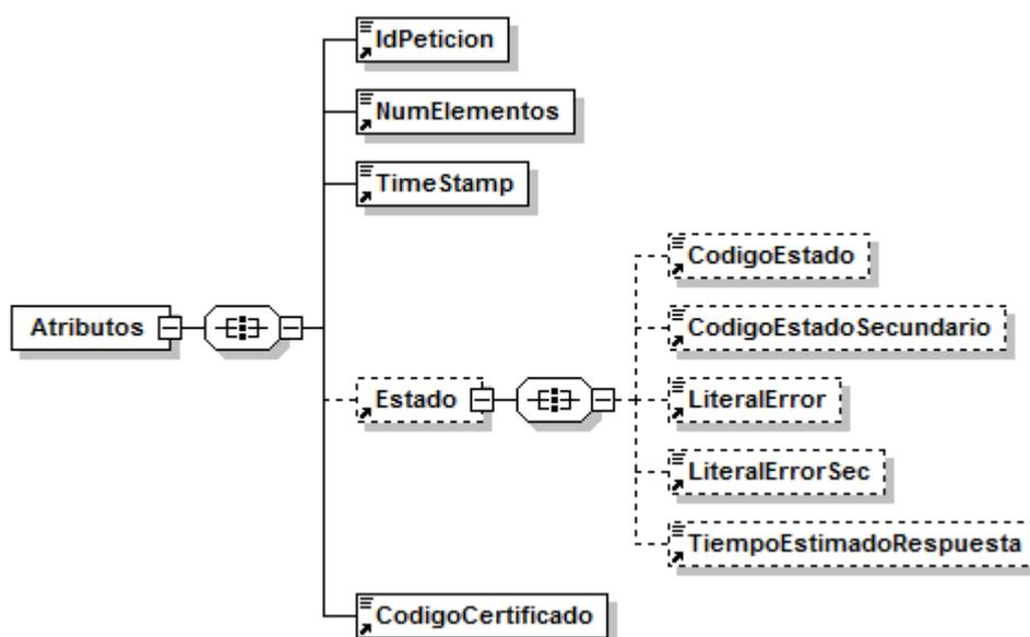
Figura 12. Diagrama del mensaje SOAP Fault del Servicio
