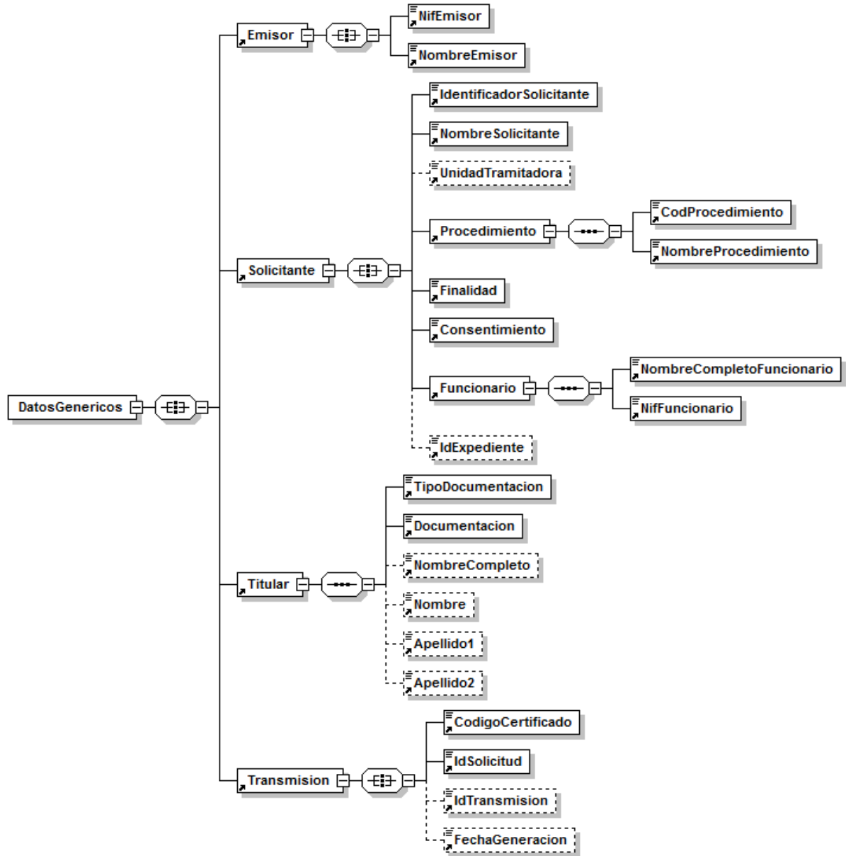
Figura 4.- Diagrama de la rama de DatosGenericos del mensaje de petición del Servicio
